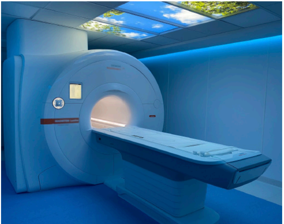
Nueva sala de resonancia magnética de 3T, diseño minimalista, túnel amplio, reducción de ruido y decoración con sky view que en conjunto proporcionan una mejor experiencia para el paciente durante el estudio.
